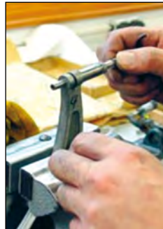
Einbau einer neuen Mikrometerspindel Mounting of a new micrometer spindle
