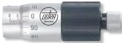
Ablesung 0,01mm, Spindelsteigung 1,0mm (100 Teilstriche auf der Trommel, Ablesung ohne Addition)
