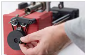
Antrieb durch seitliches Handrad Drive with hand wheel on side face
