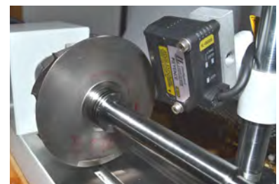
LASER Messvorrichtung für Turbinenschaufeln LASER measuring system for turbine wheels
