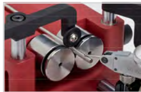
Niederhalter für kleine Durchmesser Spring loaded workpiece clamping system for small diameters
