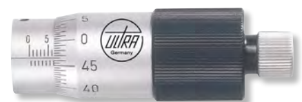
Ablesung 0,005mm, Spindelsteigung 0,5mm (100 Teilstriche auf der Trommel)
