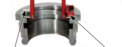
Messstiefenanschlag für beweglichen Messarm Measuring depth stop for movable arm
