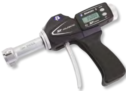
Digital-Innen-Schnellmessgerät mit balligen Messflächen für eine gute Wiederholgenauigkeit auch ohne Übereinstimmung der Bohrungsmitte. Lieferbar für Ø 6-300mm.
