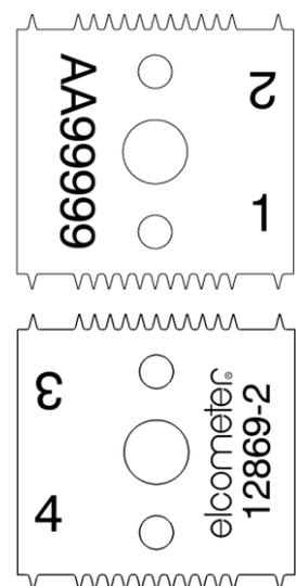
*Note : La norme ISO/JIS préconise de remplacer l'outil de coupe lorsque le sommet des lames présente un aplatissement de 0.1 mm.*
