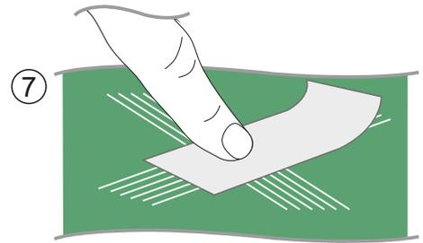
7 Legen Sie das abgeschnittene Band über das Gittermuster und glätten Sie es mit einem Finger. Reiben Sie das Klebeband kräftig mit einem Fingernagel oder einer Fingerspitze, um eine gute Haftung des Bands an der Beschichtung zu gewährleisten.
