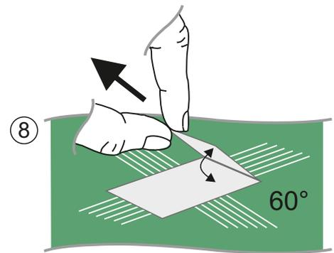
8 Ziehen Sie das Klebeband innerhalb von 5 Minuten nach dem Anbringen mit einer einzigen gleichmäßigen Bewegung von 0,5 bis 1 Sekunde Dauer in einem Winkel von 60° von der Oberfläche ab.
