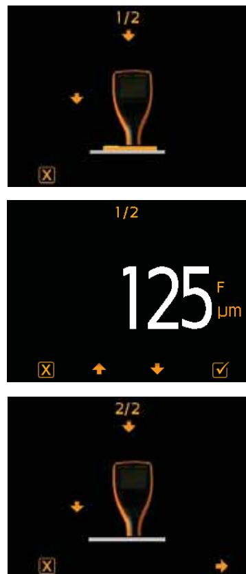
*Note : les jauge FNF doivent être calibrées en mode ferreux et non-ferreux pour garantir la précision des mesures.*
