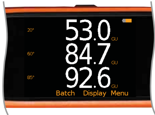
Mesure de brillance sous les 3 angles
